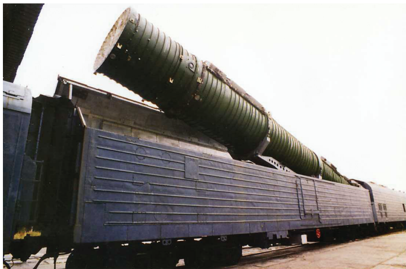
Пусковая установка боевого железнодорожного ракетного комплекса
